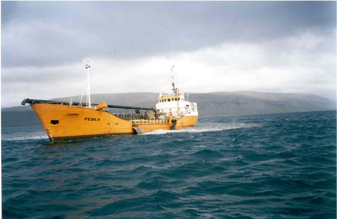
Mynd 2.3 Tilraunadæling við Otradal sumarið 2001. Gruggmökkur hefur myndast umhverfis skipið. Sjá má lítinn foss af gruggmettuðum sjó falla frá skipinu (Mynd: Jóhannes Briem).
